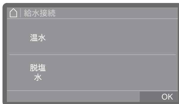
給水接続をタップすることで選択または選択解除できます。有効化された給水接続は色で強調表示されます。
