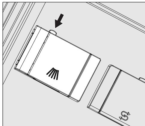
■ //の記号が付いたディスペンサーテンクの黄色のボタンを押します。
