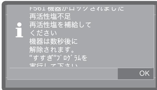
■ ディスプレイの指示に従い、再活性塩を補充します(□❸「再活性塩コンテナの充填」を参照)。塩を補充すると、一定時間の遅延後に機器のロックが自動的に解除されます。
