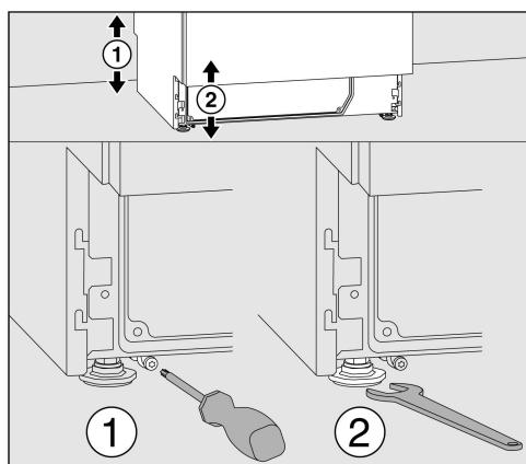
前面の機器脚は、オープンスパナ(スパナサイズ13)で調整可能です。後部の脚はT20トルクスネジで調整してください。
