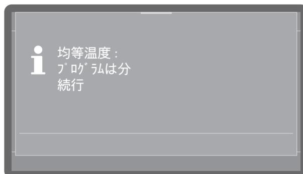
この時点で洗浄庫の温度が60 °Cを超える場合、まず圧力の調整が行われます。その後、プログラムが継続します。
