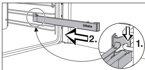
■ Prenda a calha telescópica FlexiClip à frente na guia inferior de um nível de encaixe (1.º) e deslize-a ao longo dessa guia para o interior do forno (2.º).
