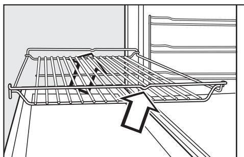
Encaixe as peças com a proteção contra extração atrás.
