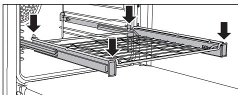
As calhas telescópicas FlexiClip suportam, no máximo, 15 kg de peso.
