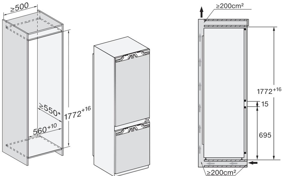
\* Заявленный расход электроэнергии рассчитан для глубины ниши 560 мм. В нише глубиной 550 мм прибор будет полностью работоспособен, однако расход электроэнергии немного увеличится.
