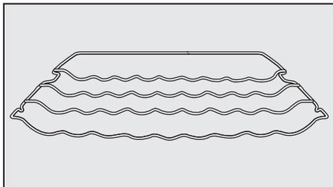
С помощью полочки Вы можете разложить бутылки в холодильнике в горизонтальном положении, чтобы компактно их хранить.
