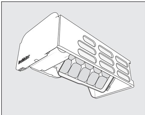
Как только вода замерзает, кубики льда автоматически попадают в выдвижной контейнер из встроенной формы для льда. Эта форма не вынимается из прибора.
