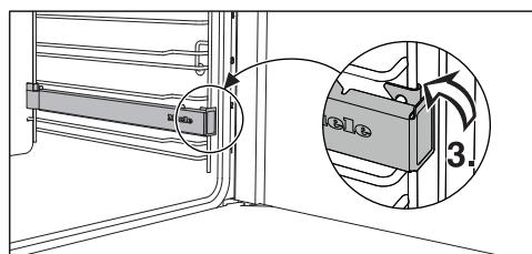
■ 然后将 FlexiClip 灵动滑轨固定在搁架层较低的轨道上 (3.)。
