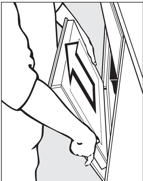
■ 握住机门的任意一侧，并沿对角方向向上拉，将其从夹持器中拉出。确保机门成直线关回。
