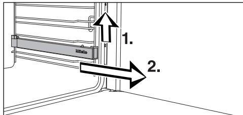
■ 从前面抬起 FlexiClip 灵动滑轨，将其拆下 (1.)，然后沿着搁架层轨道向前拉出 (2.)。
