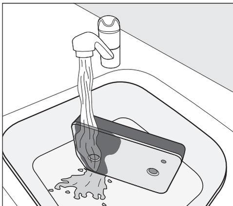
**Conseil :** Pour que les résidus présents sur la surface se détachent plus rapidement, faites passer un jet d'eau à la verticale sur la face avant du filtre de socle.
