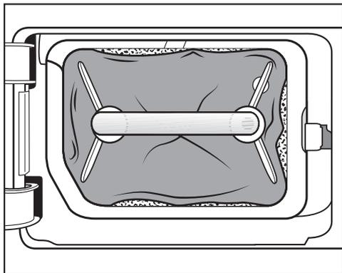
Les bords du filtre de socle ne sont pas en contact et le filtre de socle est déformé. Les peluches ne sont pas filtrées au niveau des bords et sont entraînées dans l'échangeur thermique. À la longue, l'échangeur thermique s'encrasse.
