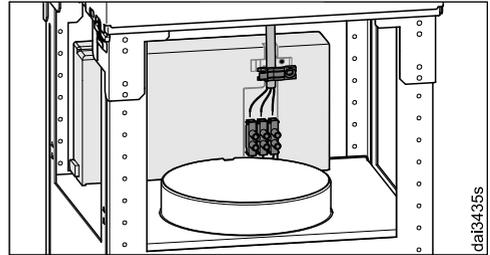
Für einen einwandfreien Anschluss muss die vorhandene Zugentlastung verwendet werden.
