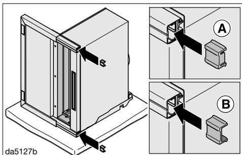
■ Insira os batentes de profundidade nas calhas da pala por trás. O alinhamento depende de quanto para a frente pretende mover o batente.
