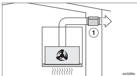
No modo de exaustão, o silenciador atenua tanto o ruído do ventilador para o exterior, como o ruído do exterior que entra na cozinha através do tubo de exaustão (p. ex. o ruído da rua). Para isso, o silenciador deve ser posicionado o mais próximo possível da saída de ar (1).
