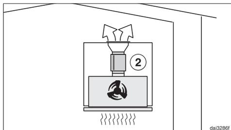
No modo de circulação de ar, o silenciador é posicionado entre a válvula de segurança e a grelha (2). Verifique o espaço de montagem.
