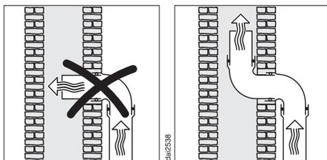
Quando o ar for evacuado através de uma chaminé, o bocal de saída do tubo deve ser orientado no sentido do fluxo.
