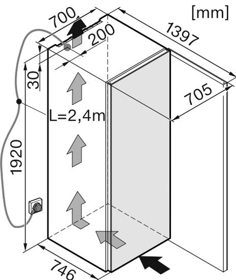
\* Dimensions sans entretoises murales montées. Si vous avez monté des entretoises, la profondeur de l'appareil augmente de 35 mm.
