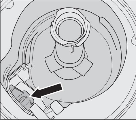
Sotto la copertura si trova la pompa di scarico (freccia).
