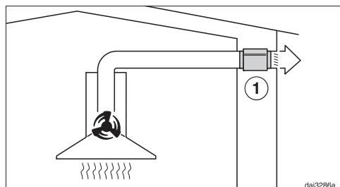
Kod načina rada na odvod zraka, prigušivač buke prigušuje kako zvukove ventila-tora prema van tako i vanjske zvukove, koji putem cijevi za odvod zraka prodiru u kuhinju (npr. ulična buka). Stoga se prigušivač buke postavlja što je moguće bliže izlaza zraka ①.
