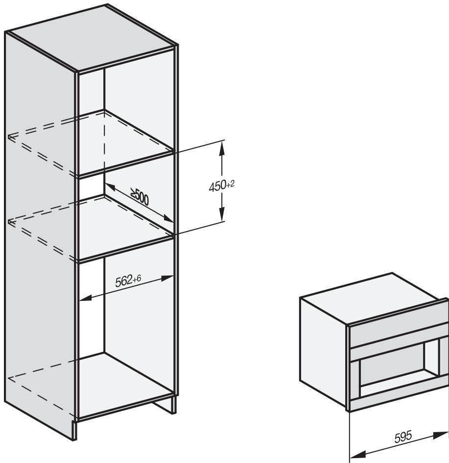
Une combinaison avec d'autres appareils encastrables Miele est possible. Dans ce cas, il est impératif de prévoir un plancher intermédiaire fermé entre la machine à café et l'appareil situé en dessous. Une combinaison avec un tiroir chauffant Gourmet/tiroir de mise sous vide encastrable ne requiert pas de plancher intermédiaire.
