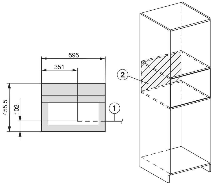
① Câble de raccordement au réseau
