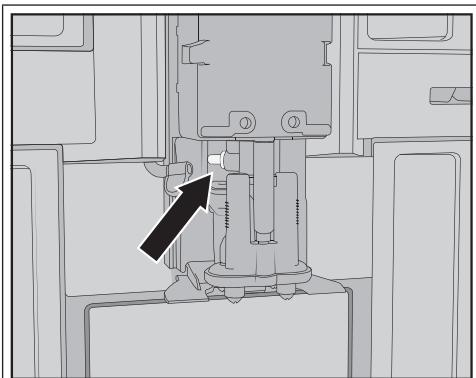
Ne retirez **pas** la pièce de raccordement du conduit de lait.
