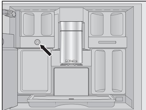
La vanne de lait est située sous le réservoir à grains gauche.
