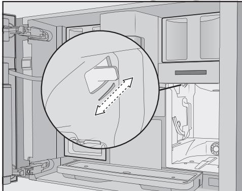
■ Actionnez le levier du degré de mouture **d'exactement 1 cran** vers l'avant (mouture plus fine) ou vers l'arrière (plus grosse mouture).
