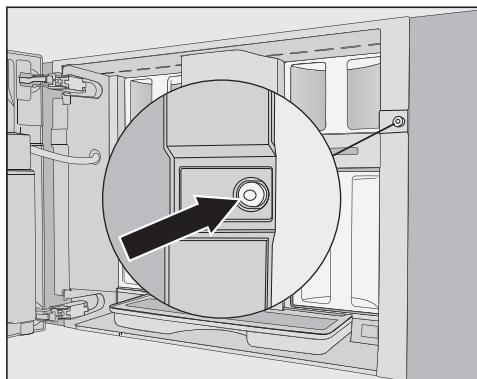
Un ergot en silicone rouge se trouve dans le trou de la vis, permettant de sécuriser la porte de l'appareil pendant le transport et d'éviter ainsi les dommages dus au transport sur l'appareil.
