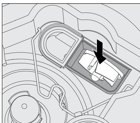
Por baixo da válvula antirretorno encontra-se o impulsor da bomba de esgoto.
