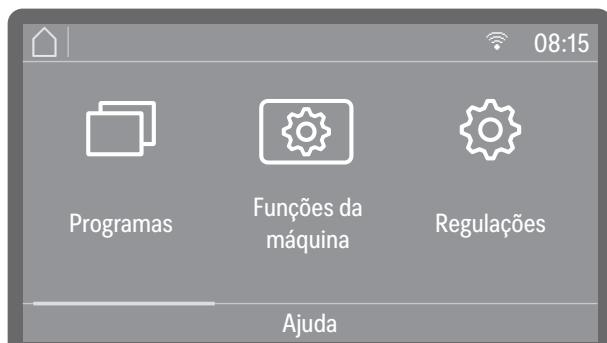
No caso de máquinas de lavar e desinfetar ligadas em rede, na parte superior do visor aparece o ícone da interface disponível. Wi-Fi representa uma ligação Wi-Fi; L uma ligação LAN por cabo. Se a máquina de lavar e desinfetar não conseguir estabelecer uma ligação Wi-Fi ao router, o símbolo é exibido com um risco em conformidade ✅.
