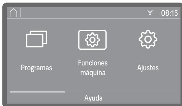
En el caso de lavadoras desinfectadoras con conectividad, en la parte superior del display aparece el ícono de la interfaz disponible. WiFi significa que hay conexión WiFi disponible; LAN significa que existe una conexión LAN por cable. Si la lavadora desinfectadora no puede establecer una conexión WiFi con el router, el símbolo aparece tachado.
