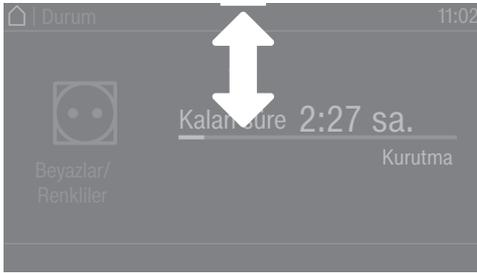
Ekranın üst kenarının ortasında turuncu renkli bir çubuk görülüyorsa, açılır menünün görüntülenmesini sağlayabilirsiniz. Bu çubuğa dokununuz ve parmağınızı ekran üzerinde aşağıya doğru kaydırınız.
