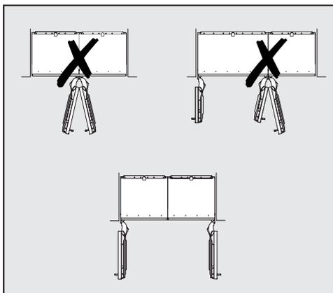
Si les deux appareils frigorifiques ne sont pas séparés par une paroi intermédiaire, ils doivent être reliés l'un à l'autre grâce au kit de montage Side-by-side. De plus, il faut installer le chauffage latéral pour éviter la formation d'eau de condensation et d'éventuels dommages en résultant.
