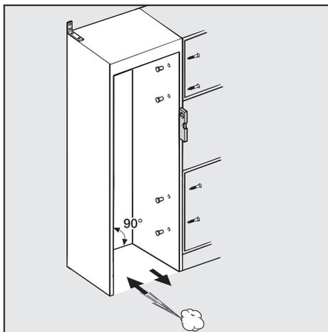
Avant le montage de l'appareil frigorifique, ajuster avec précision la niche d'encastrement à l'aide d'un niveau à bulle. Les coins de la niche doivent présenter un angle de  $90^\circ$  l'un par rapport à l'autre. Dans le cas contraire, la façade du meuble ne reposera pas sur les 4 coins de la niche d'encastrement.
