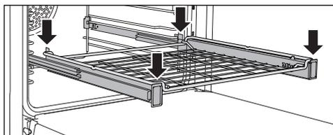
La capacidad máxima de carga de las guías telescópicas FlexiClip es de 15 kg.
