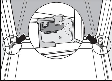
La puerta está unida a las bisagras mediante soportes. Antes de poder retirar la puerta de estos soportes es necesario desbloquear los estribos de bloqueo en ambas bisagras de la puerta.
