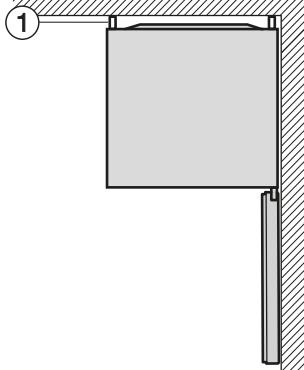
Zidni odstojnici ① na zadnjoj strani Vašeg rashladnog uređaja obezbeđuju da vlažnost koja nastaje može da se odvodi napolje.
