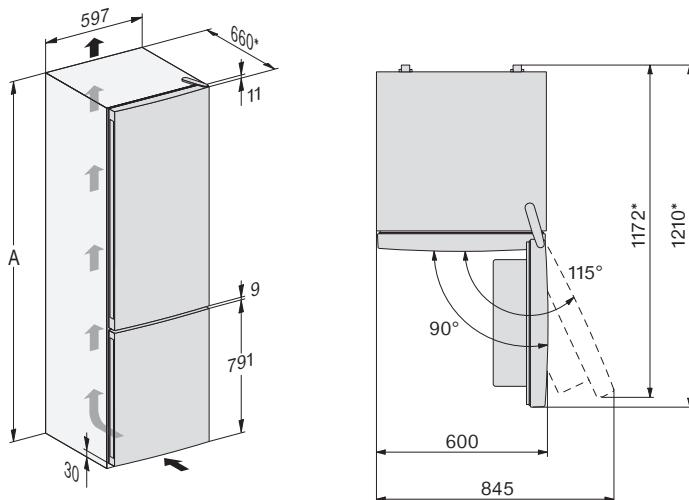
\* Dimenzija sa montiranim zidnim odstojnicima. Ukoliko se zidni odstojnici ne koriste, smanjuje se dubina rashladnog uređaja za oko 22 mm.
