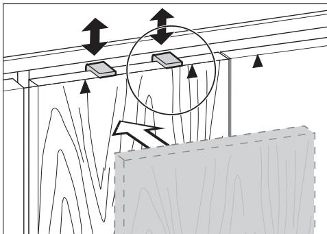
**Dica:** Deslize as ajudas de montagem ② juntamente com a frente do móvel até ficarem ao mesmo nível dos móveis situados ao lado.
