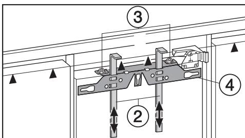
■ Desaparafuse as porcas ③ e retire a travessa de fixação ④ juntamente com as ajudas de montagem ②.
