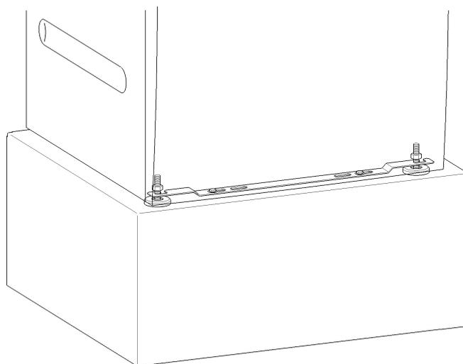
A l'aide de l'étrier de fixation joint, l'appareil est fixé au sol par les deux pieds avant. Le matériel de fixation est prévu pour une fixation par goujons sur le sol en béton.
