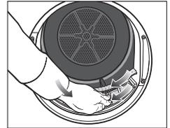
Reinigen Sie immer dann, wenn es im Display angezeigt wird. Unterschiedliche Meldungen können angezeigt werden:
