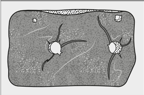
Durch Risse und Spalten werden Flusen ungefiltert in den Wärmetauscher geblasen und verursachen Verstopfungen.
