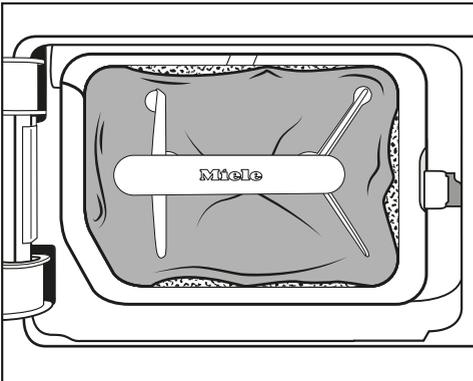
Die Ränder des Filters liegen nicht an und der Filter ist verformt. An den nicht richtig anliegenden Rändern werden Flusen ungefiltert in den Wärmetauscher geblasen. Hierdurch verstopft der Wärmetauscher auf Dauer.
