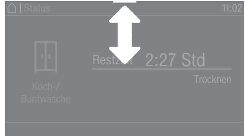
Wenn am oberen Bildschirmrand in der Mitte des Displays ein orangener Balken erscheint, können Sie sich das Pulldown-Menü anzeigen lassen. Berühren Sie den Balken und ziehen Sie den Finger auf dem Display nach unten.
