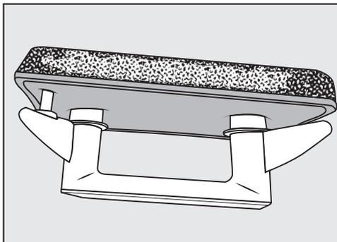
Rückstände sind auf Faserrückstände der Wäsche und verbliebene Waschmittelbestandteile zurückzuführen, die den Filter verstopfen. Rückstände finden Sie auf der Vorderseite und auch an den Seitenrändern des Filters. In Extremfällen bilden diese Rückstände hartnäckige Verkrustungen.
