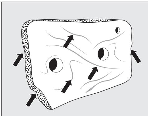
Les déformations sont visibles sur les bords latéraux et sur l'ensemble du filtre de socle.
