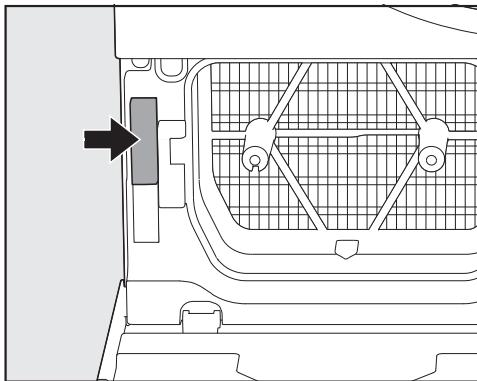
Le retrait du support entraîne l'activation d'un élément de sécurité (flèche). L'élément de sécurité empêche la fermeture du panneau de socle sans le support inséré. L'insertion du support entraîne la désactivation de l'élément de sécurité.
