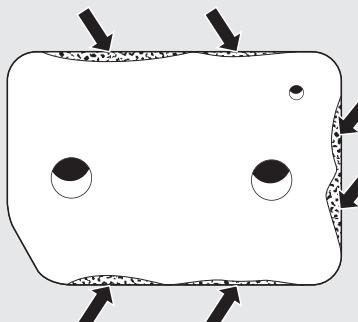
⚠ Dommages provoqués par un filtre de socle endommagé ou usé. L'échangeur thermique est encastré et peut être endommagé. Vérifiez le filtre de socle conformément à la section "Remplacer le filtre de socle" au chapitre "Correction des problèmes". Remplacez le filtre de socle, si nécessaire.
