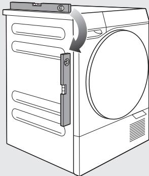
Pour pouvoir fonctionner correctement, ce sèche-linge doit être bien d'aplomb.
