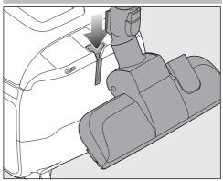
■ 将刷头插入吸尘器的停驻系统中。
