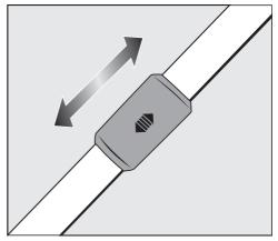
■ 握住释放机构,将伸缩管长度调整到 合适状态。
