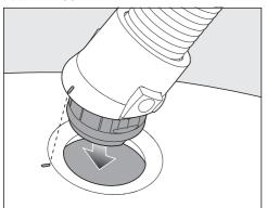
■ 将软管连接器插入吸尘器的吸入口, 直至其卡入到位。要卡入到位,需将 两个部件上的导轨对齐。
