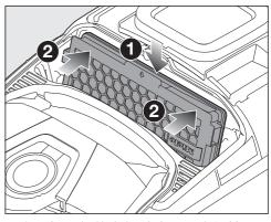
■ 向下插入新的空气过滤网,确保其正确插入,然后将其两侧向后按压,直至卡入到位。
