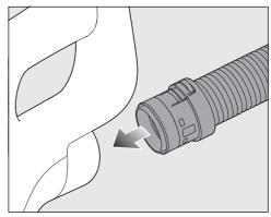
■ 将吸尘软管连接器安装到手柄中,直至卡入到位。
