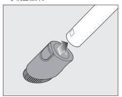
■ 将除尘刷推到吸尘管上,直到卡入到 位。
