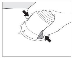
■ 按下软管连接器侧面的释放按钮,将 软管从吸入口中抬出。
