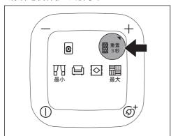
每次更换空气过滤网时都必须重置指示 灯。执行此操作时,必须打开吸尘器。
