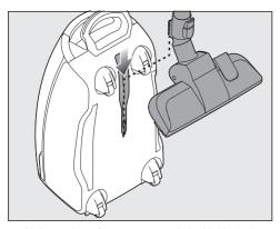
■ 将机头向下插入吸尘器底部的停驻附 件。
