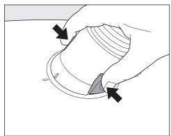
■ 按下软管连接器侧面的释放按钮,将 软管从吸入口中拉出。
