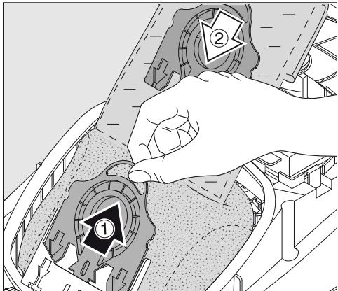
① Ziehen Sie den Staubsaugerbeutel an der Griffflasche aus der Aufnahme.
