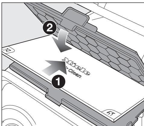
Wenn Sie anstelle des Abluftfilters HE-PA AirClean einen Abluftfilter AirClean einsetzen, müssen Sie diesen Abluftfilter unbedingt in ein Filtergitter einlegen (siehe Kapitel „Nachkaufbares Zubehör“, Abschnitt „Filter“).
