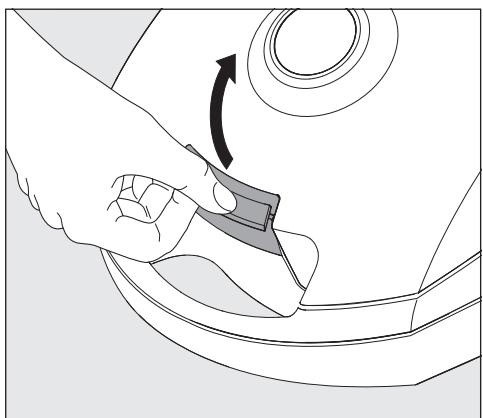
■ Ziehen Sie die Entriegelungstaste nach oben und klappen Sie den Staubraumdeckel bis zum Einrasten auf.
