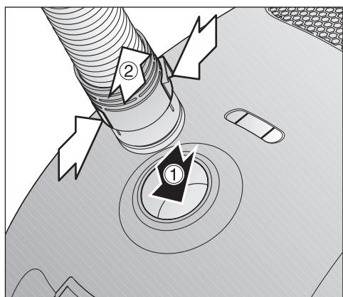
① Stecken Sie einen Anschlussstutzen bis zum deutlichen Einrasten in die Saugöffnung des Staubsaugers.
