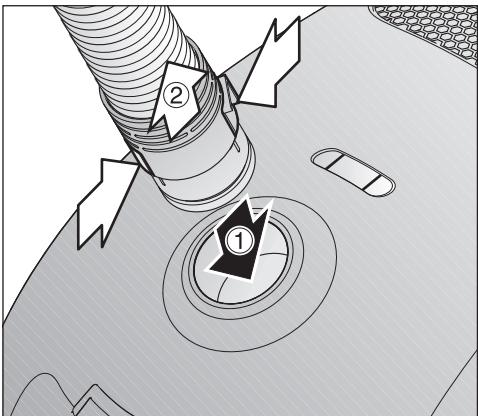
② Drücken Sie beide Entriegelungstas-ten seitlich am Anschlussstutzen und ziehen Sie den Anschlussstutzen aus der Saugöffnung.
