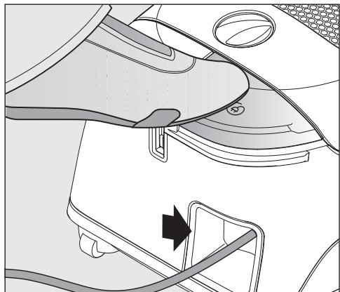
■ Treten Sie die Fußtaste für die automatische Kabelaufwicklung – das Anschlusskabel rollt automatisch auf.
