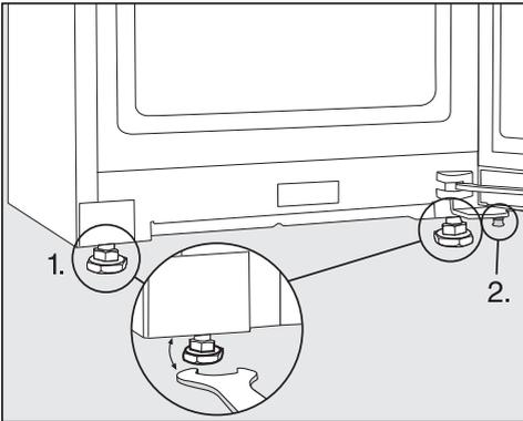
■ Regolare l'apparecchio con una livella a bolla d'aria e la chiave fornita e sostenere lo sportello.
