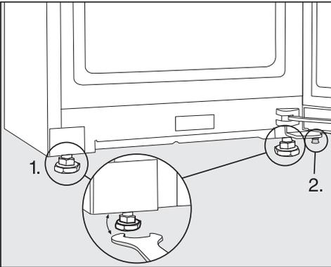
■ Vycentrujte chladničku pomocou vodováhy a priloženého vidlicového kľúča a podoprite dvierka prístroja.
