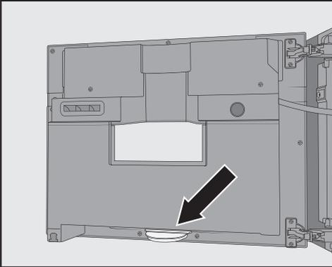
Unten an der Innenseite der Gerätetür befindet sich die Tropfschale.
