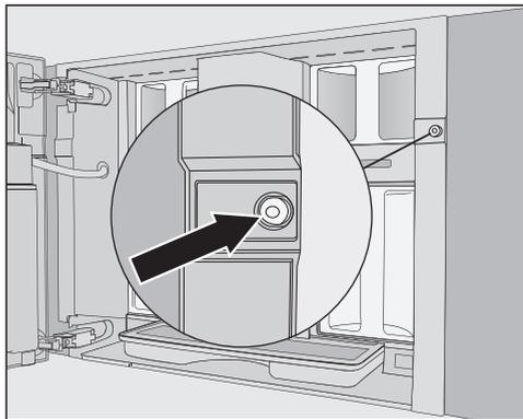
In dem Schraubenloch befindet sich eine rote Silikonkappe, die die Gerätetür während des Transports sichert und so Transportschäden am Gerät verhindert.
