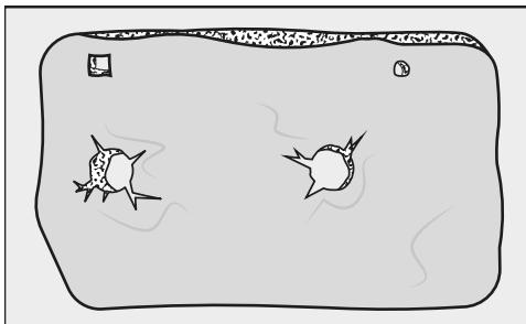
Durch Risse und Spalten werden Flusen ungefiltert in den Wärmetauscher geblasen und verursachen Verstopfungen.
