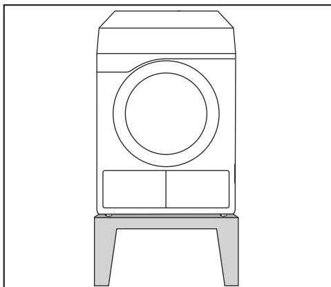
Stahlsockel\* (offene oder geschlossene Unterbauten)
