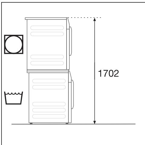
Ein Verbindungssatz\* (APCL001) ist erforderlich. Die Montage muss durch eine von Miele autorisierte Fachkraft erfolgen. Sichernen Sie die Waschmaschine mit dem der Waschmaschine mitgelieferten Befestigungsbügel.
