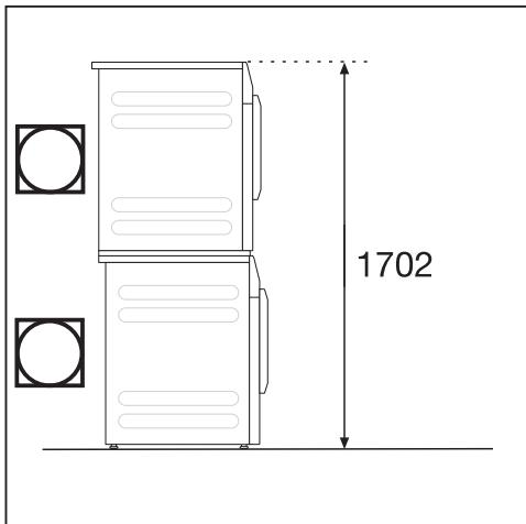
2 Miele Trockner können als Trockensäule aufgestellt werden. Dazu ist ein Verbindungsbausatz\* erforderlich. Die Montage muss durch eine von Miele autorisierte Fachkraft erfolgen.
