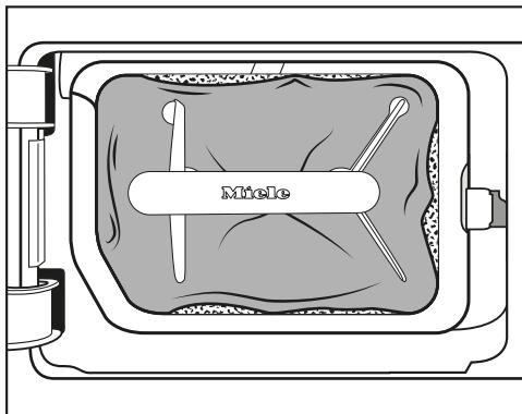
Die Ränder des Filters liegen nicht an und der Filter ist verformt. An den nicht richtig anliegenden Rändern werden Flusen ungefiltert in den Wärmetauscher geblasen. Hierdurch verstopt der Wärmetauscher auf Dauer.
