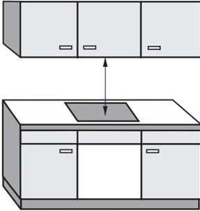
Entre la placa de cocción y una campana extractora colocada encima se deberá mantener la distancia de seguridad indicada por el fabricante de la campana.
