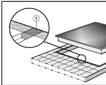
► Las ranuras ① y la zona rayada situada por debajo de la superficie auxiliar de la placa de cocción deberán ser lisas y regulares para que la placa de cocción asiente de forma homogénea y la junta por debajo del borde de la parte superior del aparato garantice el sellado con la encimera.
