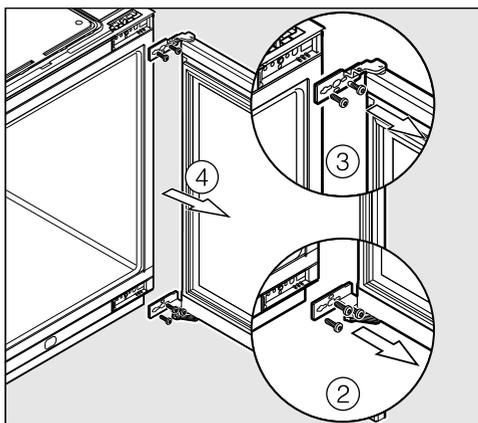
■ Afloje los tornillos. Primero los tornillos inferiores ②, luego los superiores ③.
