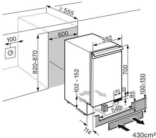
Antes del montaje, asegúrese de que el armario de empotramiento se corresponde con las medidas de empotramiento correctas. Las secciones transversales de ventilación deben respetarse estrictamente y el recorte en el zócalo para la rejilla de ventilación que se suministra debe estar centrado con el acondicionador para garantizar su correcto funcionamiento.
