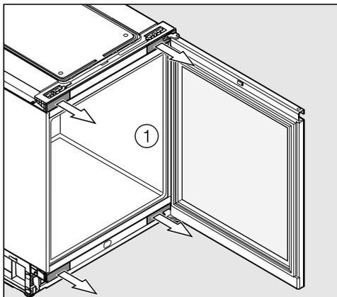
■ Retire las tapas ① con la ayuda de un destornillador.
