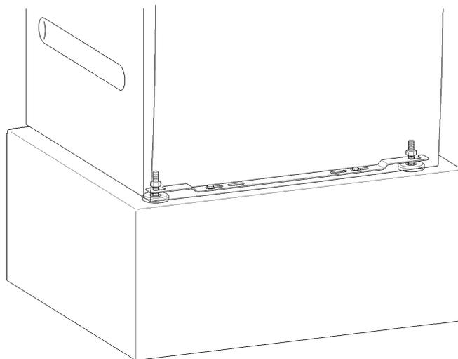
Com o estribo de fixação em anexo, o aparelho é fixo ao piso através de ambas as bases dianteiras. O material de fixação foi concebido para uma fixação com buchas sobre piso de betão.
