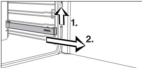
■ Soulevez le rail coulissant FlexiClip par l'avant (1.) et sortez-le en le faisant glisser le long de la barre (2.).
