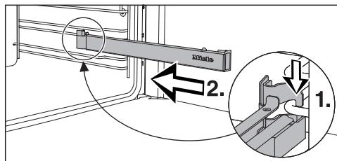
■ Insérez le rail télescopique FlexiClip par l'avant, sur la tige support inférieure d'un niveau (1) et faites-le glisser le long de la tige dans l'enceinte de cuisson (2.).
