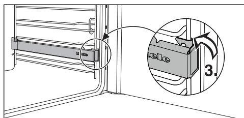
■ Enclenchez le rail télescopique FlexiClip sur la tige support inférieure du niveau (3.).
