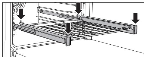
Les rails télescopiques FlexiClip peuvent supporter une charge maximale de 15 kg.
