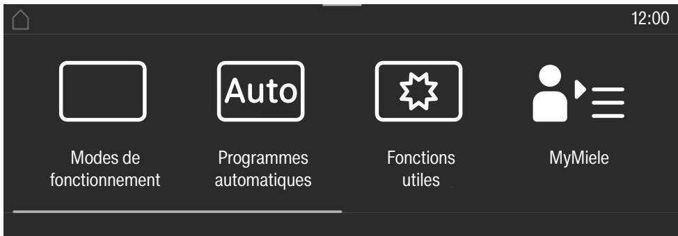
L'arborescence s'affiche à gauche dans l'**en-tête**. Les différents sous-menus sont séparés par une ligne verticale. Si l'ensemble de l'arborescence ne peut s'afficher par manque de place, le niveau situé juste au dessus est symbolisé par ... I.
