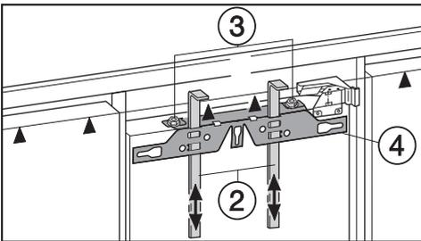
■ Schrauben Sie die Muttern ③ ab, und nehmen Sie die Befestigungstraverse ④ zusammen mit den Montagehilfen ② ab.
