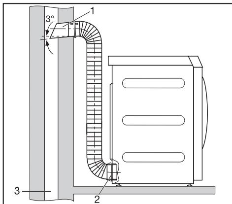
1. Tubo con bocchettone di allacciamento (=singoli componenti della cassetta a muro)
