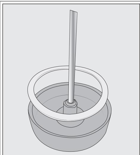
Po potrebi možete izvaditi spojni element i brtveni prsten iz poklopca boce za mlijeko. Kad ste izvadili cjevčicu od plemenitog čelika lakše ćete istisnuti spojni element iz unutarnje strane poklopca. Operite dijelove u perilici posuđa.
