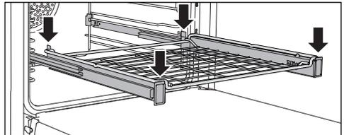
La portata massima delle guide FlexiClip è di 15 kg.
