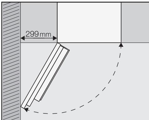
**Tipp:** Wenn zwischen der Wand und dem Kaffeevollautomaten mindestens 299 mm Abstand gegeben sind, lässt sich die Gerätetür weiter öffnen und die Handhabung ist einfacher. Z. B. lässt sich der linke Bohnenbehälter leichter entnehmen.
