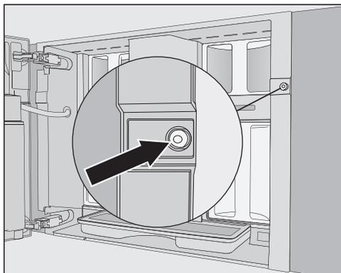
In dem Schraubenloch befindet sich eine rote Silikonknappe, die die Gerätetür während des Transports sichert und so Transportschäden am Gerät verhindert.
