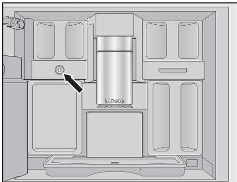
Das Milchventil befindet sich unter dem linken Bohnenbehälter.
