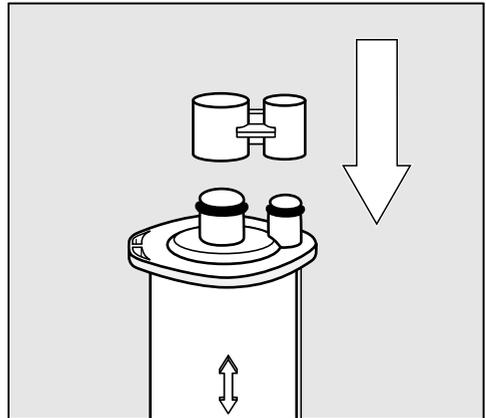
**Tipp:** Sie können die Entkalkungskartusche mit der Kappe verschließen, die sich am Kartuschenzylinder befindet. Die Kappe lässt sich leicht an der Sollbruchstelle lösen.
