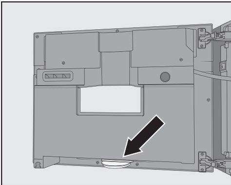
Unten an der Innenseite der Gerätetür befindet sich die Tropfschale. Reinigen Sie die Tropfschale regelmäßig.
