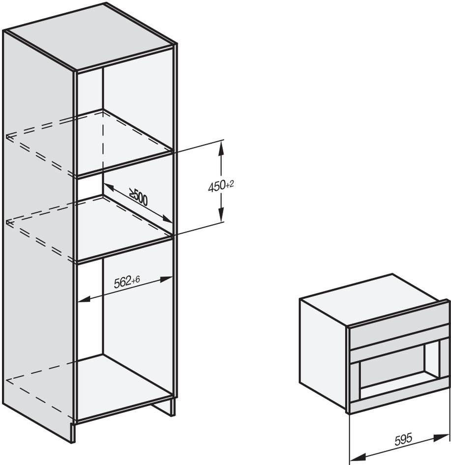
Eine Kombination mit anderen Miele Einbaugeräten ist möglich. Dabei muss der Kaffeevollautomat nach unten hin durch einen geschlossenen Zwischenboden abgegrenzt sein. Für die Kombination mit einer Gourmet-Wärmeschublade/Einbau-Vakuumierschublade ist kein Zwischenboden notwendig.
