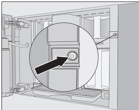
В винтовом отверстии находится красная силиконовая петля, которая защищает дверцу прибора во время транспортировки и тем самым предотвращает повреждение прибора при транспортировке.
