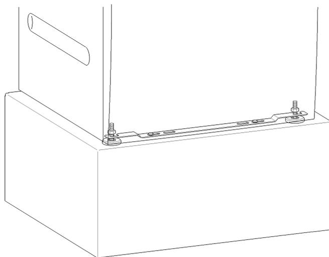
Mit dem beiliegenden Befestigungsbügel wird das Gerät über die beiden vorderen Standfüße am Boden befestigt. Das Befestigungsmaterial ist für eine Dübel-Befestigung auf Betonboden ausgelegt.
