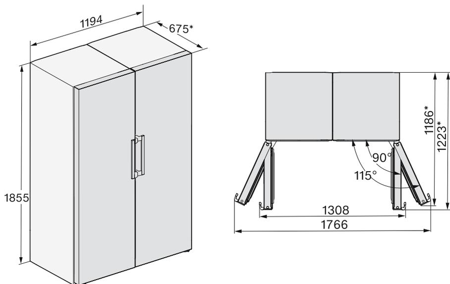
\* Dimensões sem distanciadores de parede montados. Se os distanciadores de parede fornecidos na embalagem forem utilizados, a profundidade do aparelho aumenta cerca de 15 mm.
