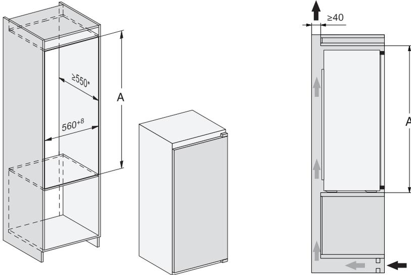
\* Para el consumo de energía declarado se ha tenido en cuenta un hueco de empotramiento de 560 mm. El aparato está equipado para funcionar a pleno rendimiento en un hueco de empotramiento de 550 mm, lo que aumenta ligeramente el consumo energético.
