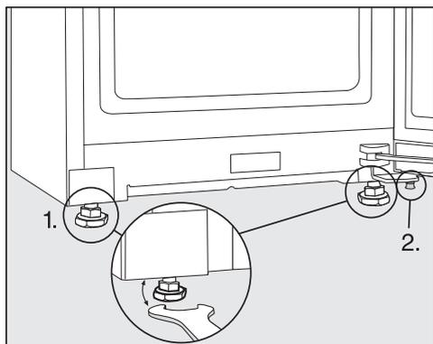
■ Regolare l'apparecchio con una livella a bolla d'aria e la chiave fornita e sostenere lo sportello.
