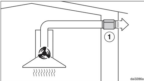
El silenciador amortigua tanto los ruidos del ventilador hacia fuera como los ruidos exteriores que entran en la cocina a través de la conducción de salida de aire (p. ej. el ruido de la calle). Para ello, el silenciador se coloca lo más cerca posible de la salida de aire ①.
