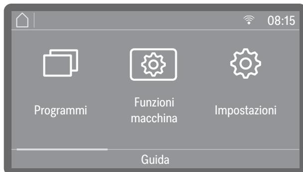
Nelle macchine per il lavaggio connesse in rete, nella parte superiore del display viene visualizzata l'icona dell'interfaccia disponibile. 📶 sta per connessione WLAN, L per connessione LAN cablata. Se la macchina non riesce a stabilire una connessione WLAN con il router, l'icona viene barrata di conseguenza 📶.
