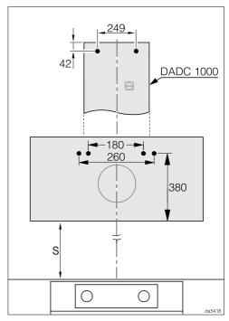
■ Wird vorab eine Rückwand angefertigt, die schon über die Befestigungslöcher verfügen soll, sind hier die Abstandsmasse der Bohrungen angegeben (Schrauben Ø 5 mm).
