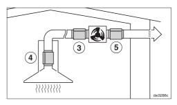
Bei Betrieb mit einem externen Gebläse können die Gebläsegeräusche nach aussen und in der Küche minimiert werden. Wenn der Schalldämpfer vor dem externen Gebläse ③ positioniert wird, verringern sich die Geräusche in der Küche. Bei einer langen Abluftleitung muss der Schalldämpfer am Abluftstutzen der Dunstabzugshaube ④ positioniert werden.
