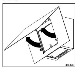
■ Ziehen Sie den Wrasenschirm unten aus der Arretierung und schwenken Sie ihn nach oben.
