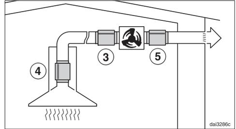
En cas de fonctionnement avec un moteur externe, les bruits du ventilateur peuvent être réduits au minimum à l'extérieur et dans la cuisine.
