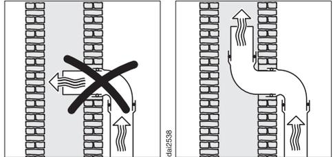
Si l'évacuation se fait dans une cheminée d'évacuation, le raccord d'introduction doit être posé dans le sens du flux d'air.
