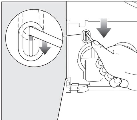
1. Натиснете механизма за аварийно отключване на вратата с помощта на отвертка изцяло надолу, без да докосвате или да отваряте вратата.
