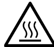
Achtung! Heiße Oberfläche!
