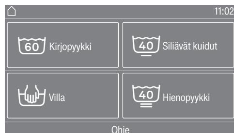
Käytettäväissä on 4–12 esiasetettua ohjelmaa. Käyttäjä ei voi tehdä muutoksia näihin ohjelmiin.
