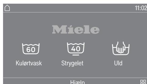
Der kan vælges mellem op til 12 forindstillede programmer. De første 3 programmer kan vælges direkte. De resterende programmer vælges via en liste ☰. Disse programmer kan ikke ændres af brugeren.
