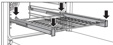
Maksimalno opterećenje FlexiClip-teleskopskih vođica iznosi 15 kg.
