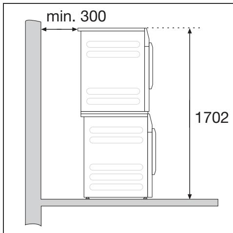
Perilica rublja može se s Miele sušilicom postaviti u stup za pranje i sušenje. U tu svrhu je potreban element za povezivanje (dodatni pribor).
